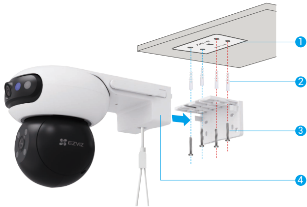
รูปที่ 1 การติดตั้งบนเพดาน
